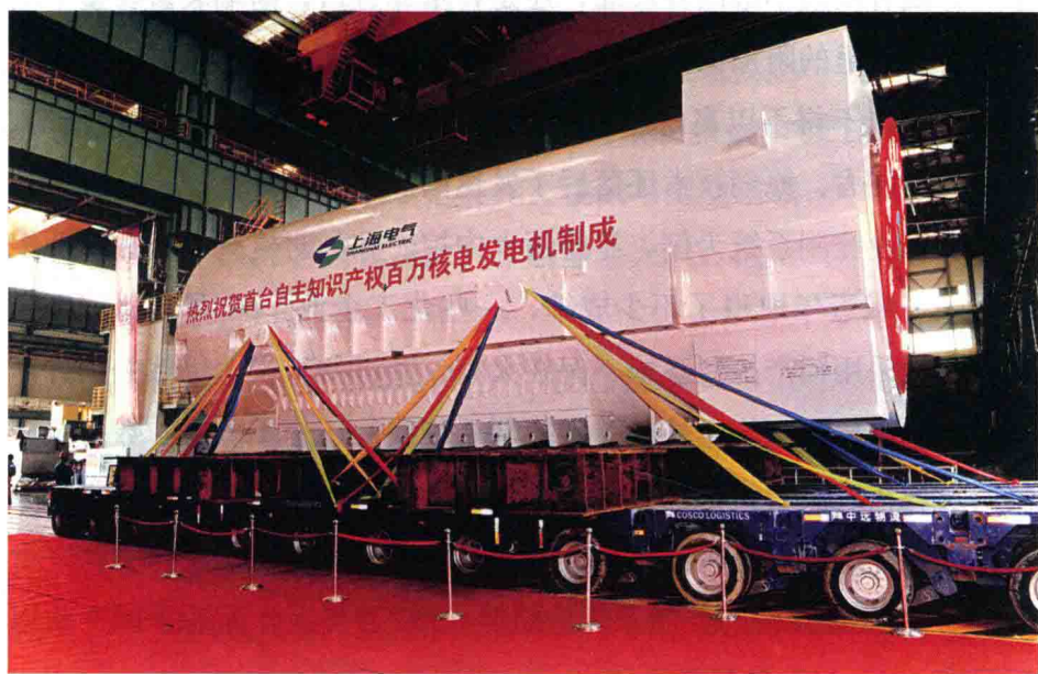
2011 年，上海电气生产的首台自主知识产权百万核电发电机。
