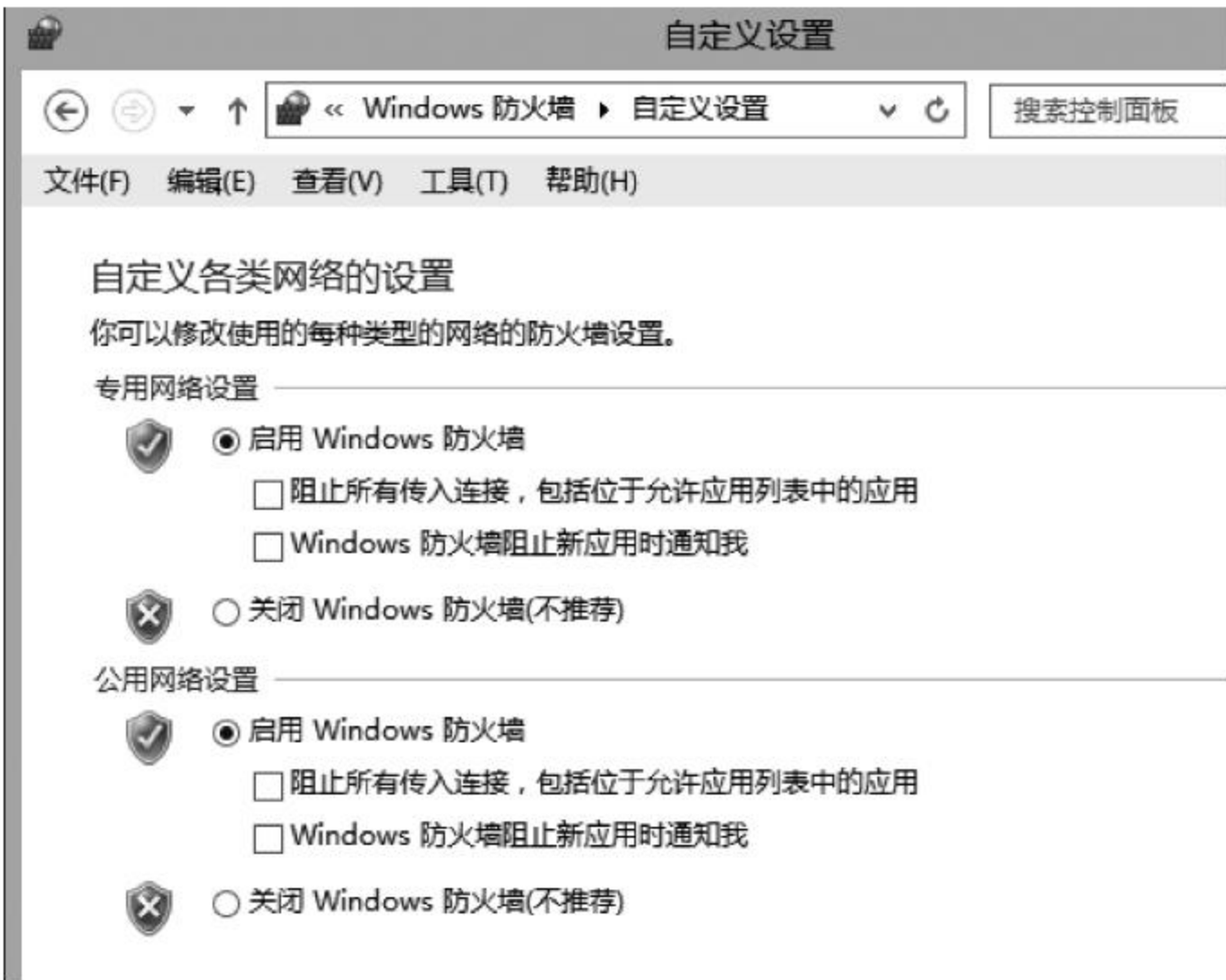
图 8-25 防火墙开启、关闭界面
