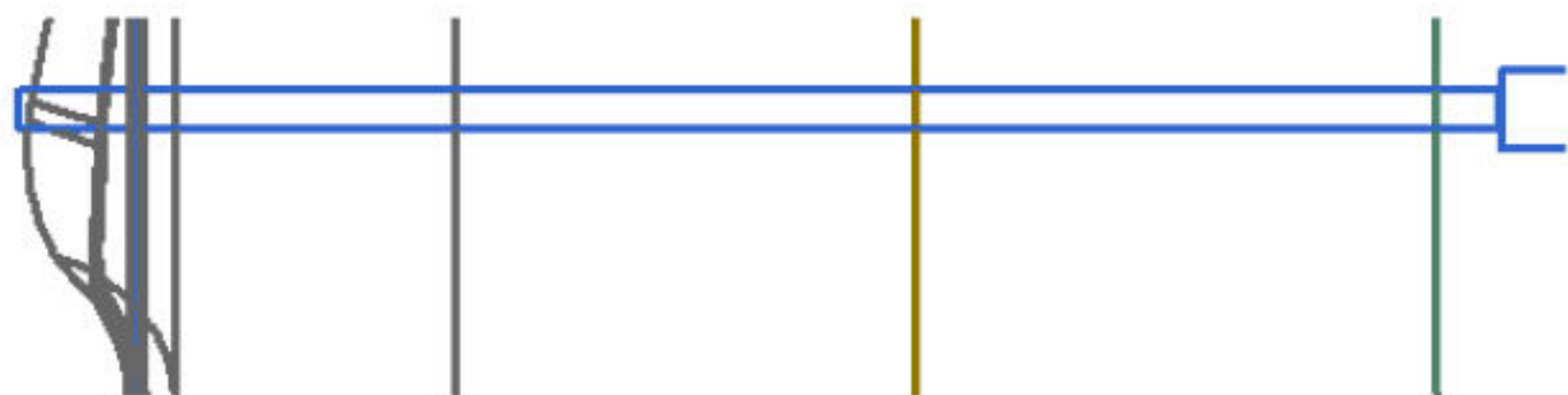
图 6.244 顶针长度比分型面高出 2~3mm
