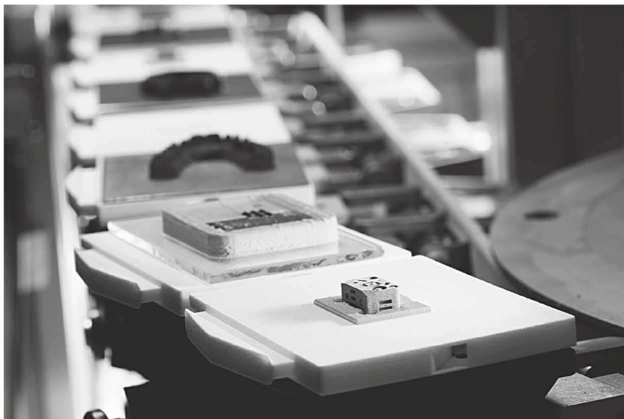
图3-6 TNO的全自动化赛道式3D打印生产系统PrintValley Hyproline
