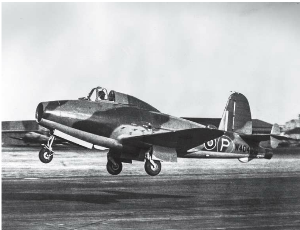
图5.5 内部装有离心式发动机的格洛斯特E. 28/39实验性喷气式飞机
