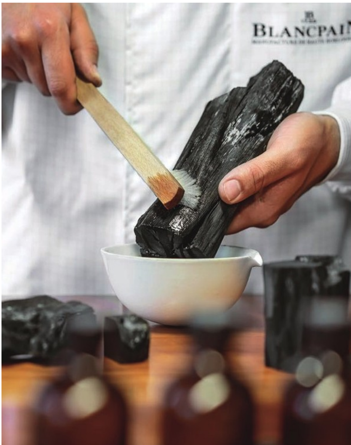
宝珀大复杂制表工坊的制表师正在进行制作备长炭表盘的第一步：洗去备长炭表面的白色附着物。
