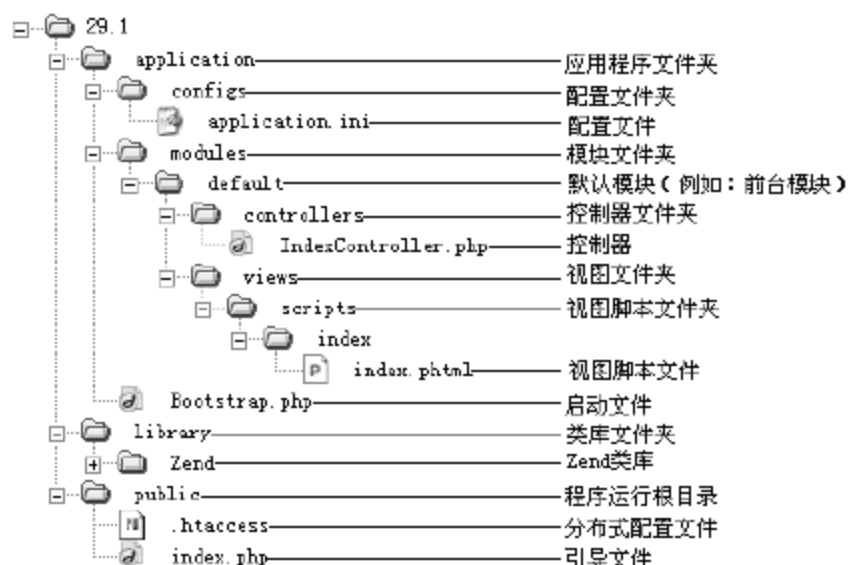
图 25.5 多模块 MVC 框架结构
