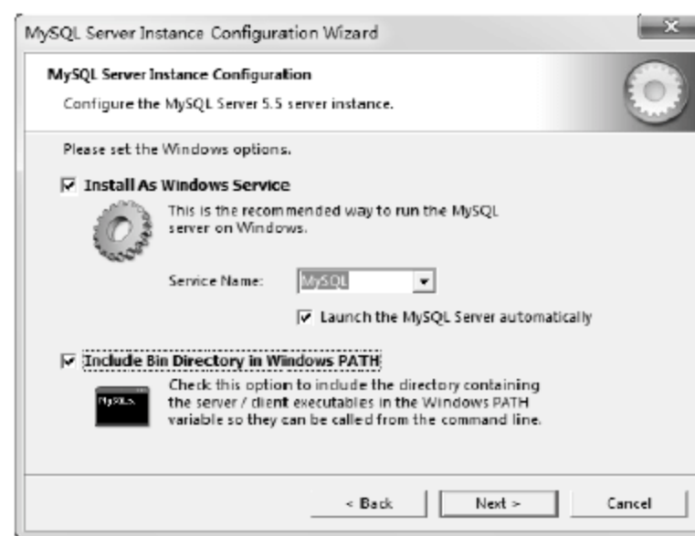
图 9.27 针对 Windows 系统进行的设置
