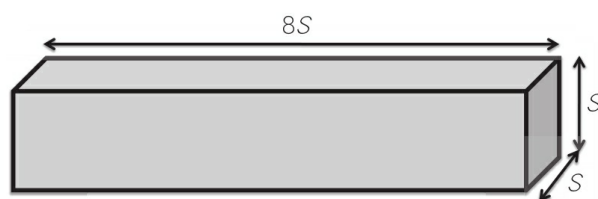
图3-1 长方体状的超级油轮：表面积= 34S^2 ，体积= 8S^3
