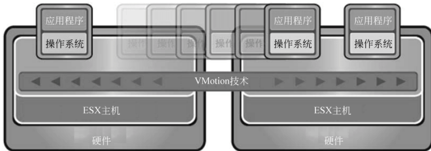
图 7-11 VMotion 技术示意图
