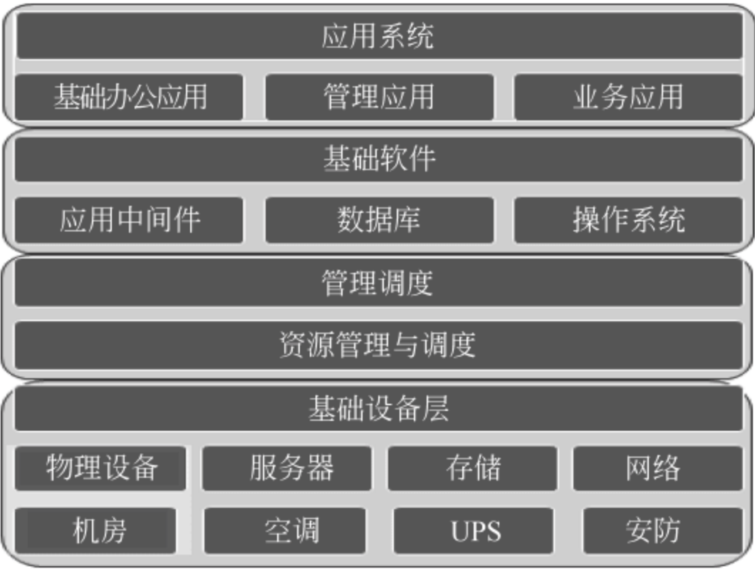
图 2-7 数据中心结构
