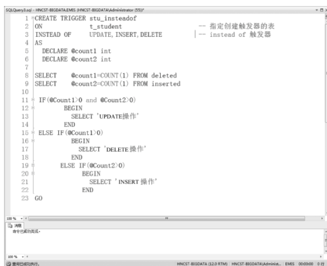
图 11-9 创建 INSTEAD OF 触发器
