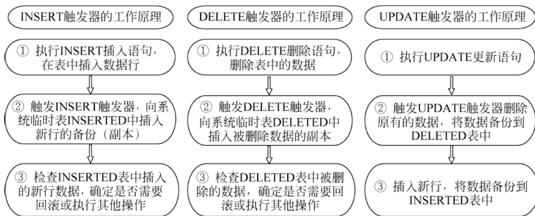
图 11-17 触发器的工作原理
