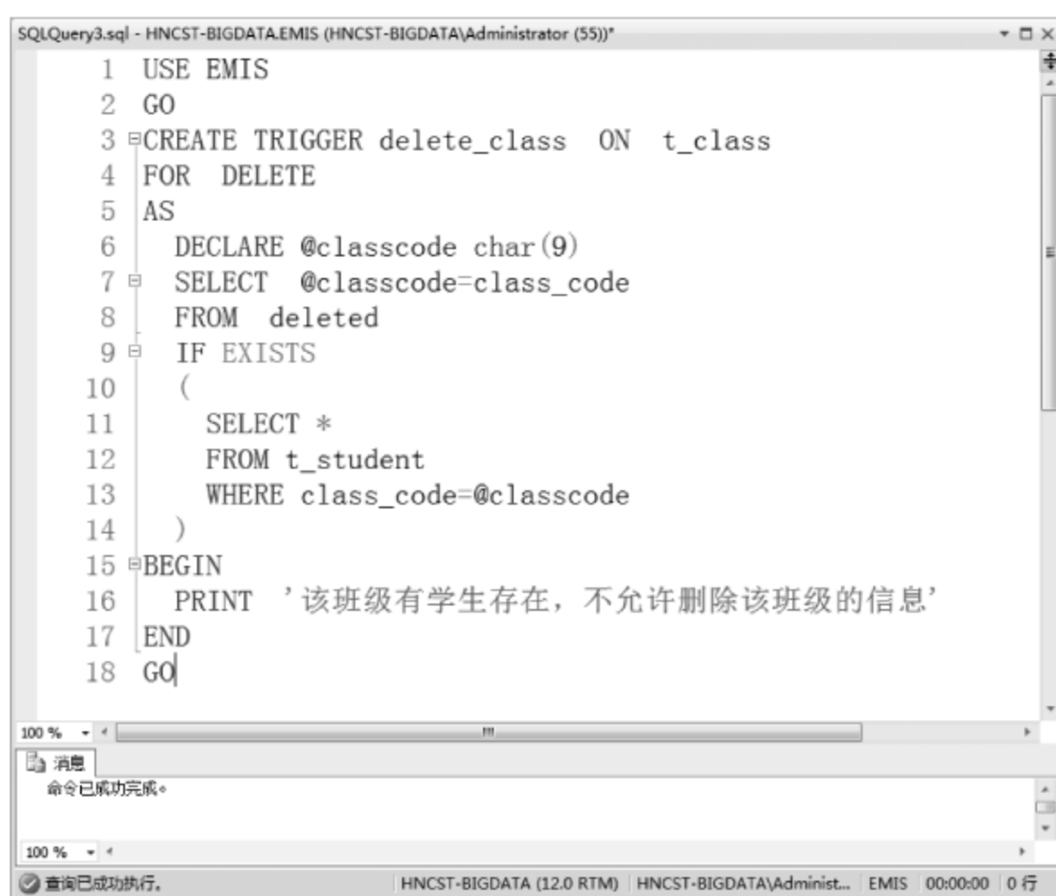
图 11-7 创建 DELETE 触发器
