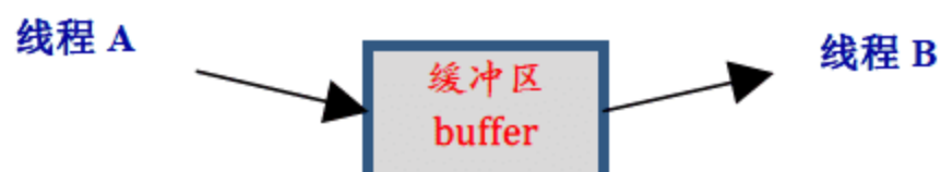
图 6-18 线程间通过缓冲区传递数据的双向同步模型
