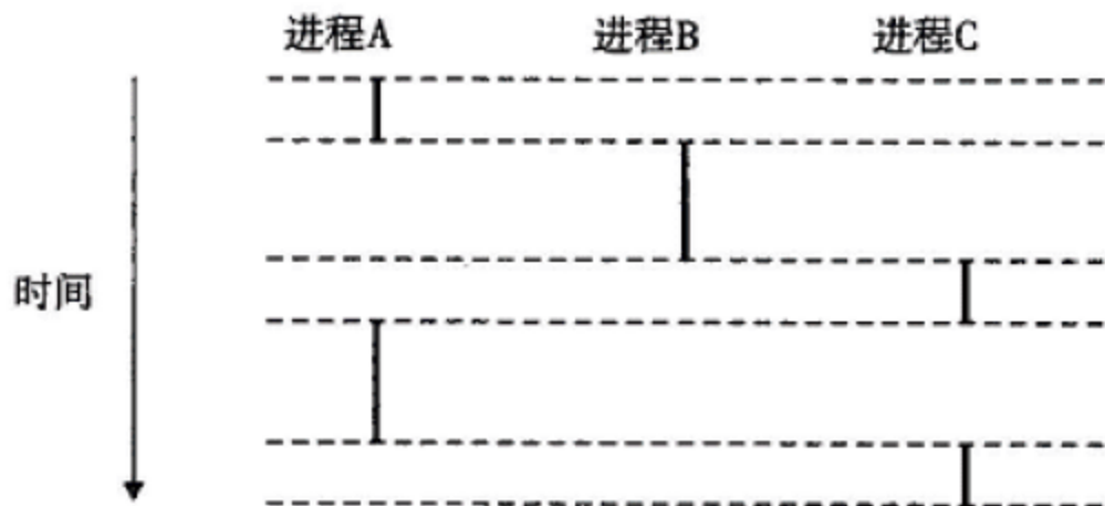
图 5-1 逻辑控制流。进程为每个程序提供了一种假象，好像程序在独占地使用处理器。 每条竖线表示一个进程的逻辑控制流的一部分
