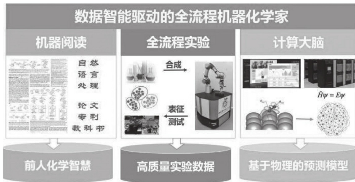
图1.6 全流程机器化学家的组成与原理
