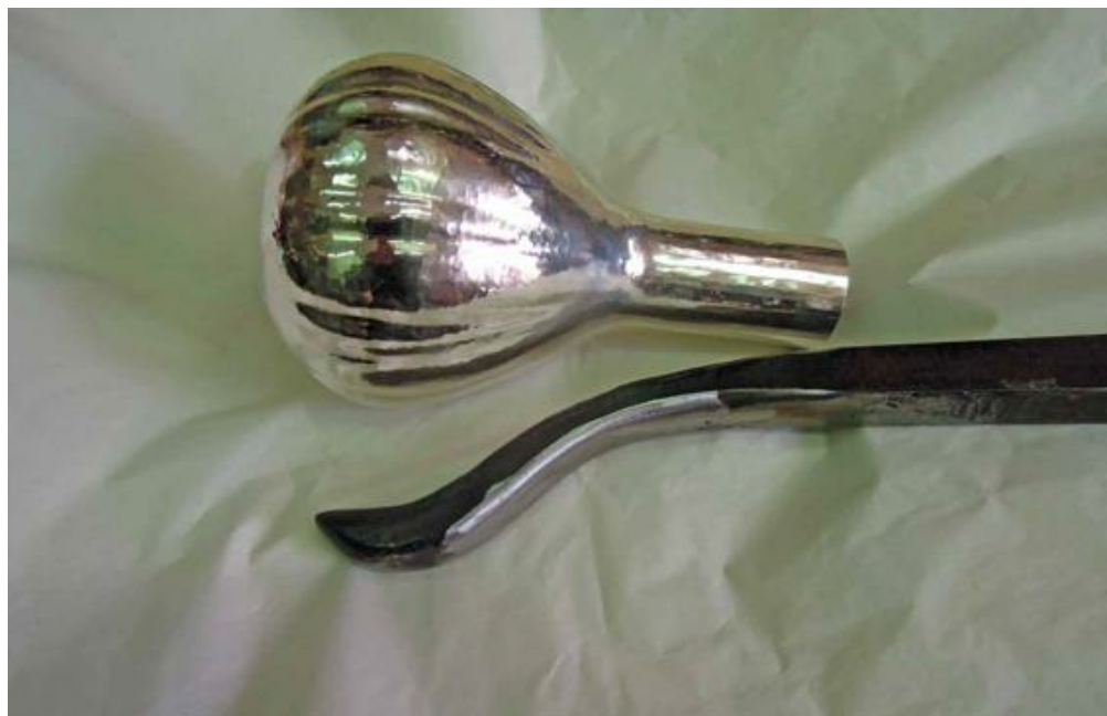
图0-3 霍尔为打造长颈细口瓶的特定曲线而专门制作的加工工具
