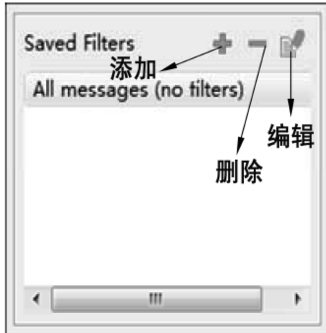
附图 2 过滤器操作面板
