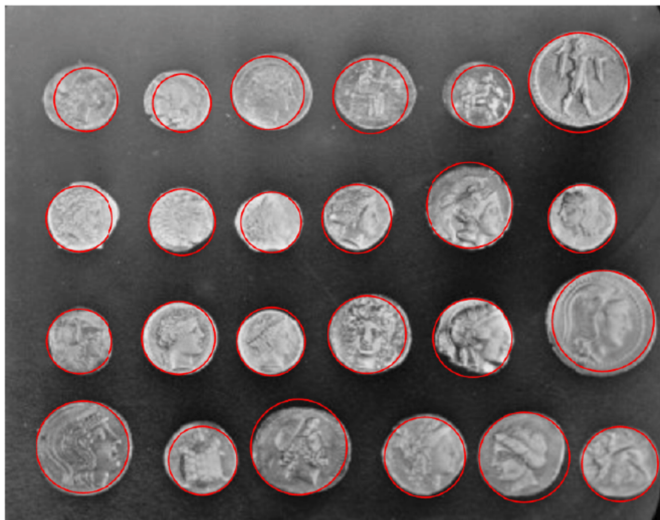
图 9-25 使用 HoughCircles()检测图像中的圆形
