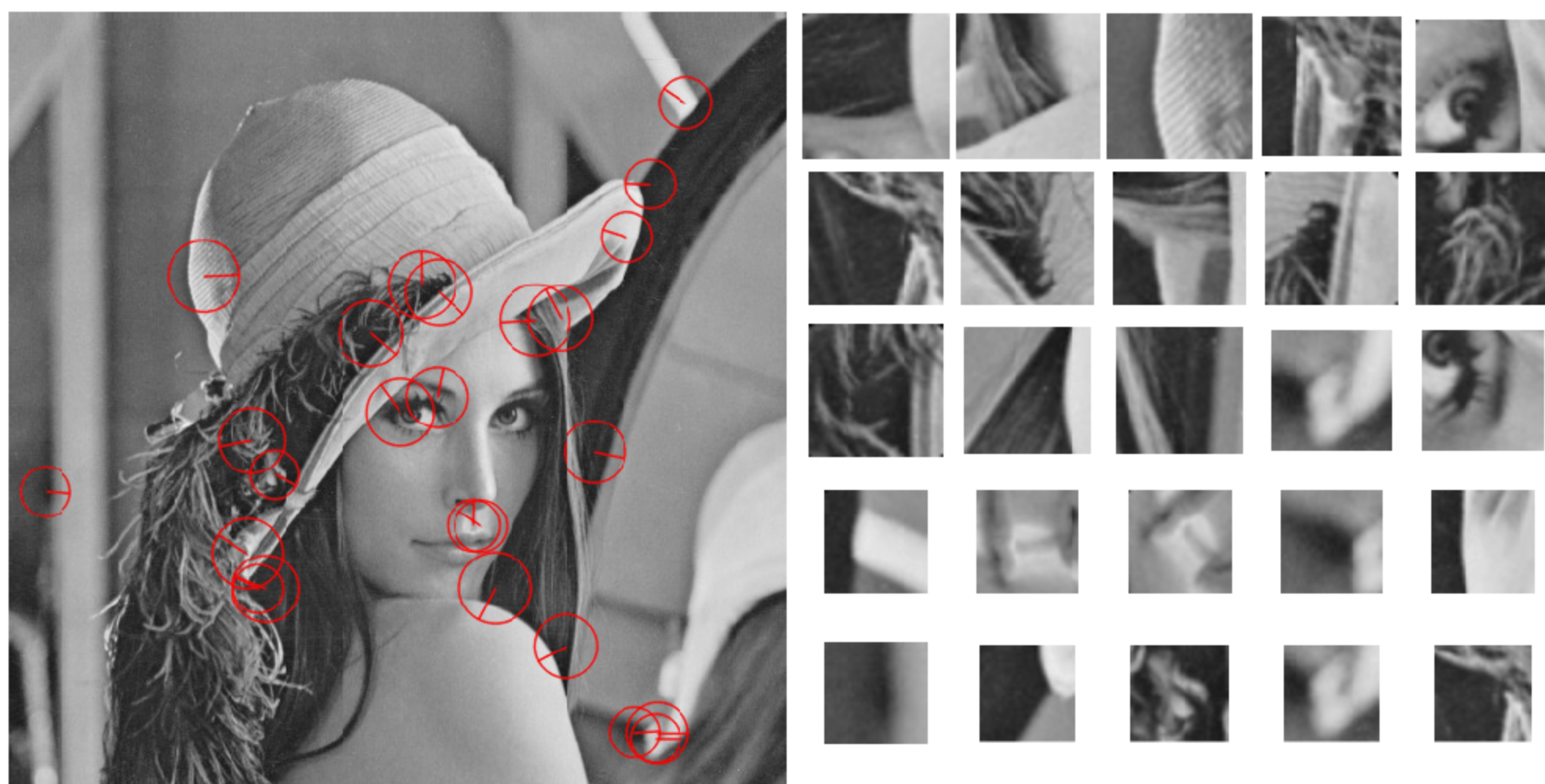
图 9-28 SURF()找到的关键点和每个关键点的局部图像
