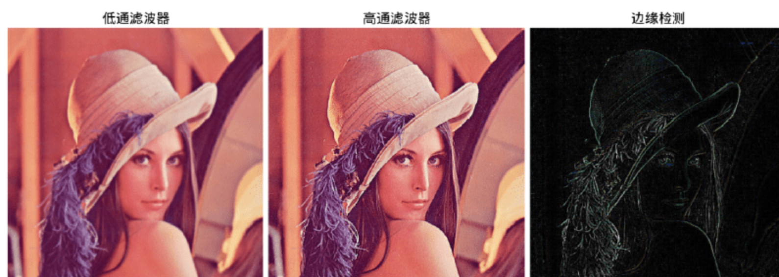
图 9-3 使用 filter2D() 制作的各種图像处理效果
