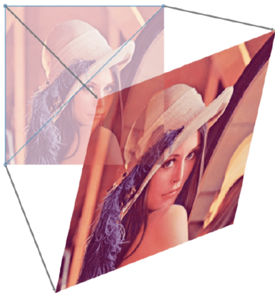
图 9-8 对图像进行仿射变换
