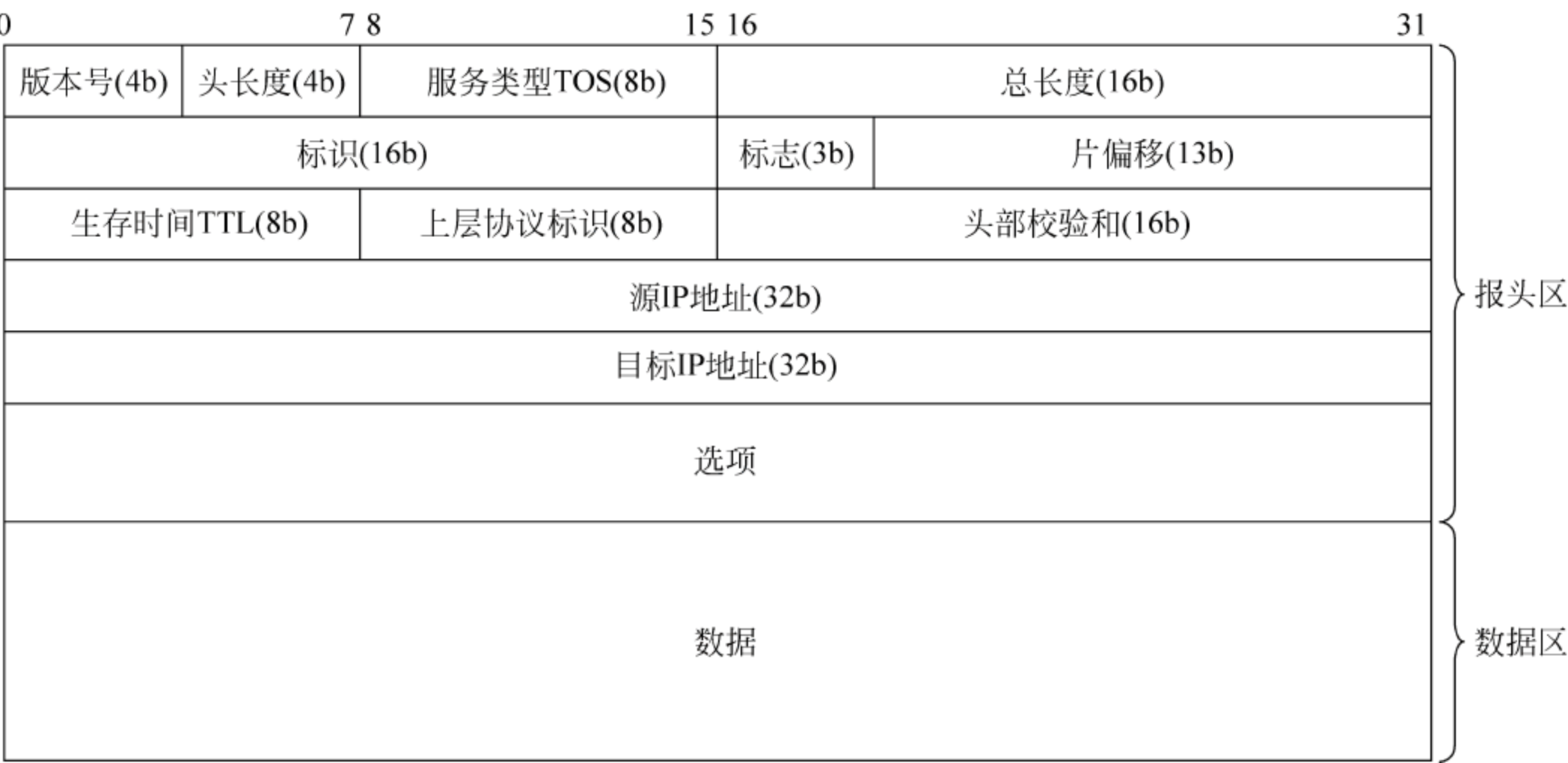
图 2-2 IP 头结构
