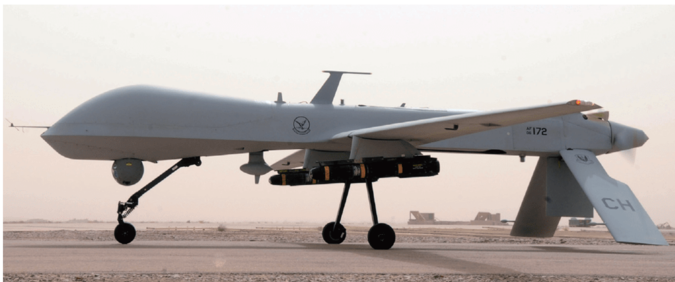
装有 AGM-114 “地狱火” 导弹的 MQ-1 无人机
