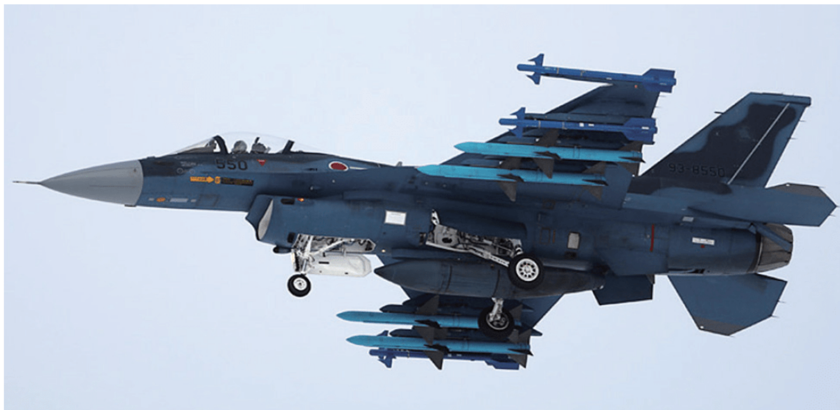
F-2 战斗机挂载的 AAM-3 导弹（机翼外侧）
