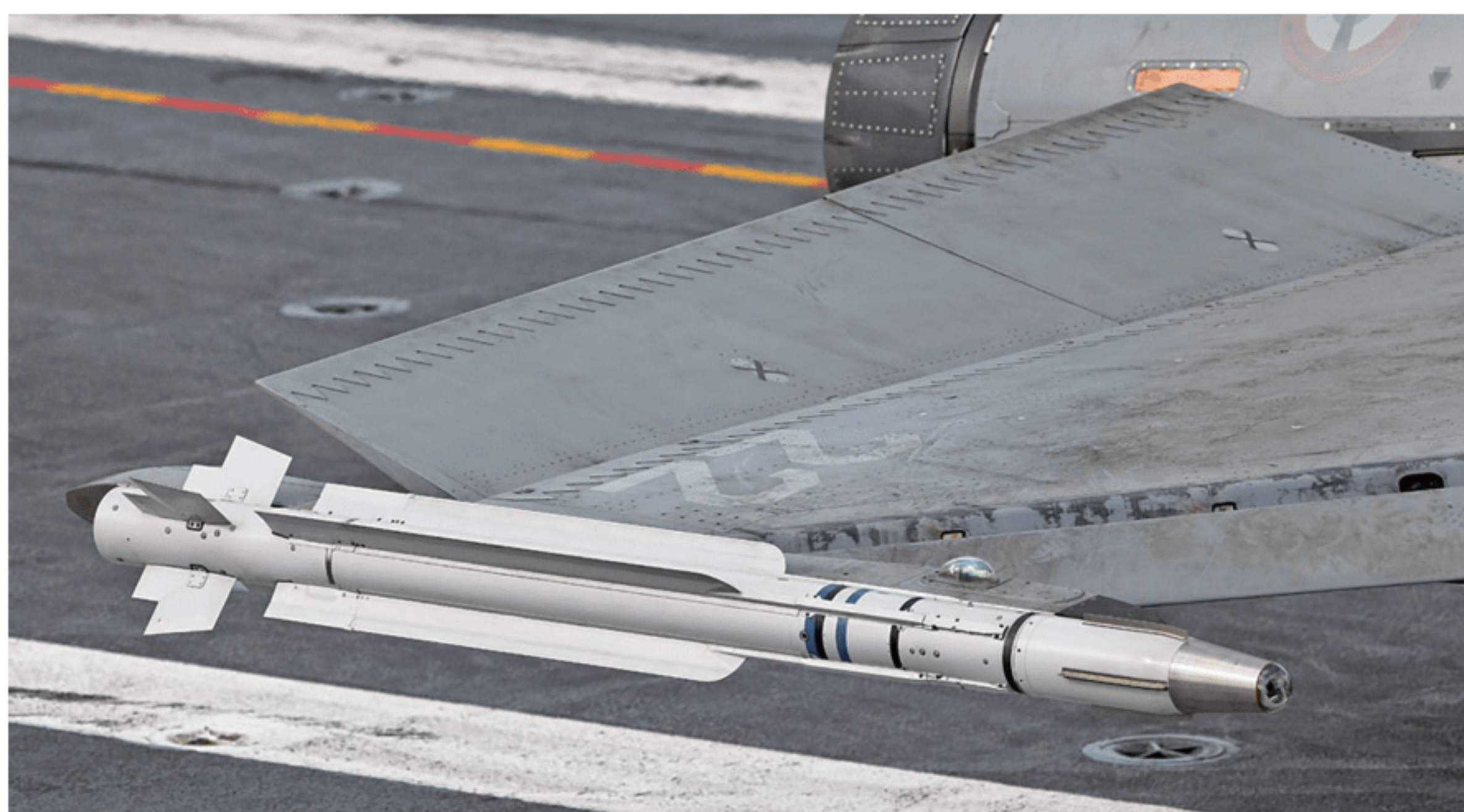
挂于机翼外侧的“米卡”导弹
