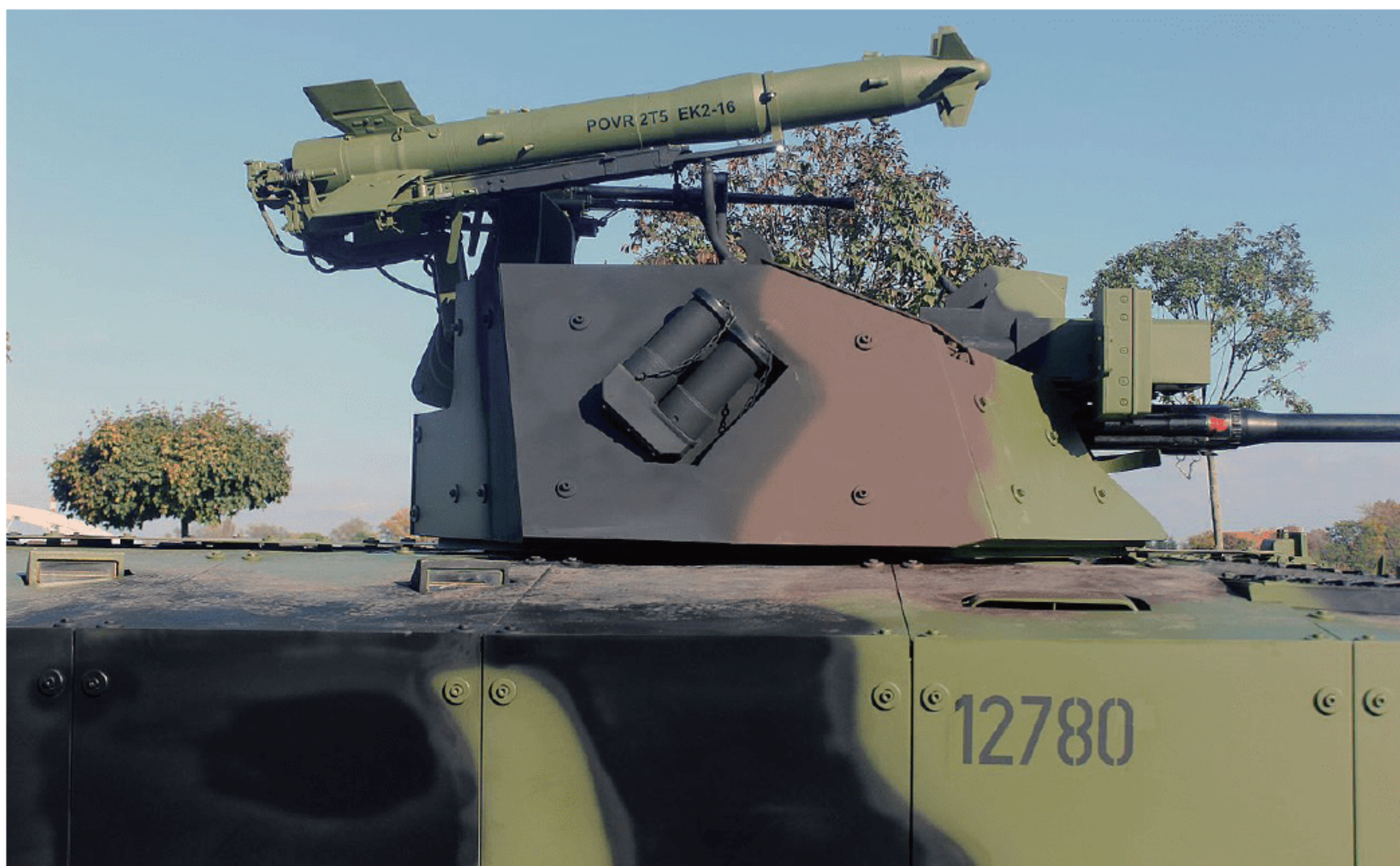
安装在 BVP M80A 步兵战车上的 9M14 “婴儿” 导弹
