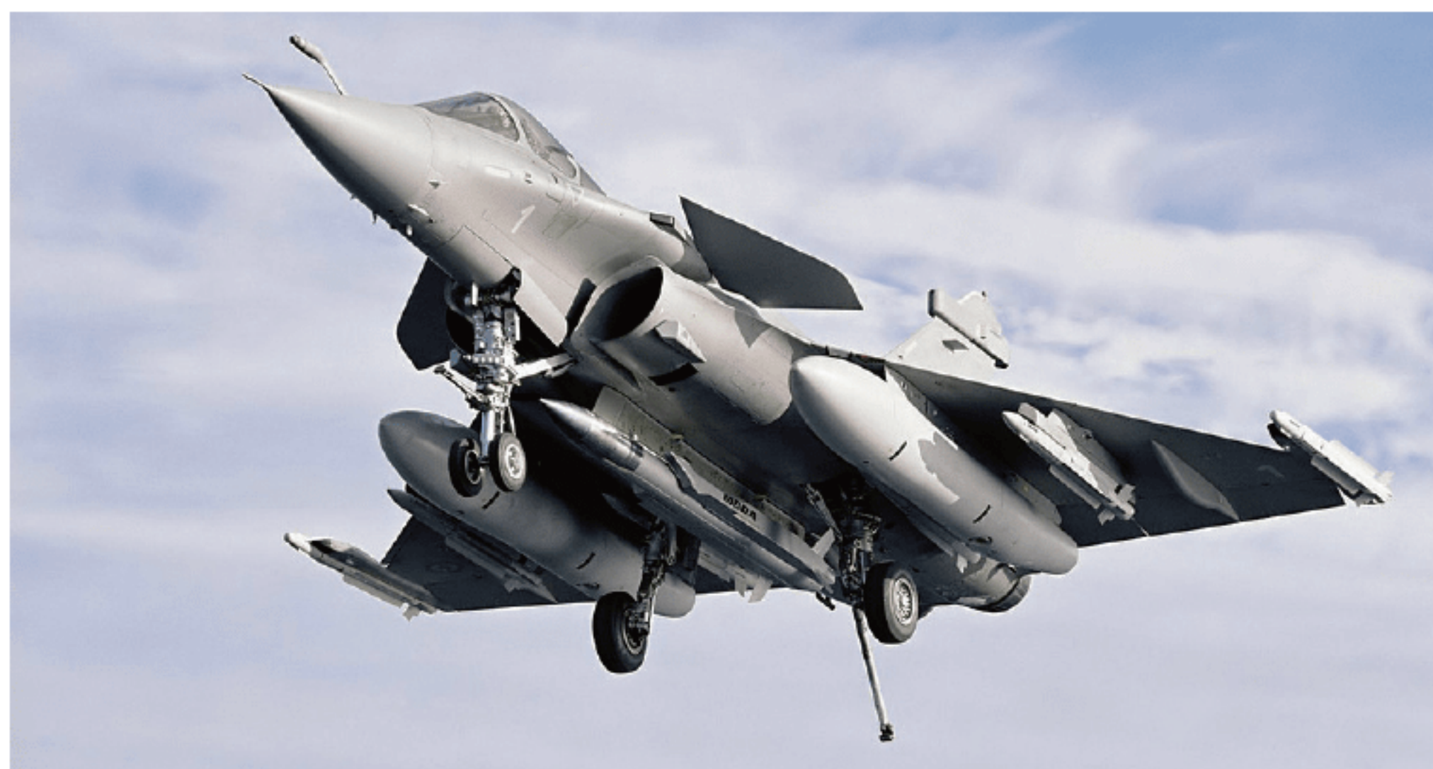
“阵风”战斗机挂载的 ASMP-A 导弹（机翼内侧）
