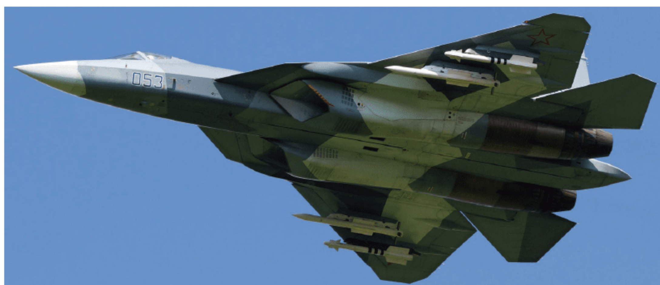
挂载 R-77 导弹（机翼内侧）的 T-50 战斗机
