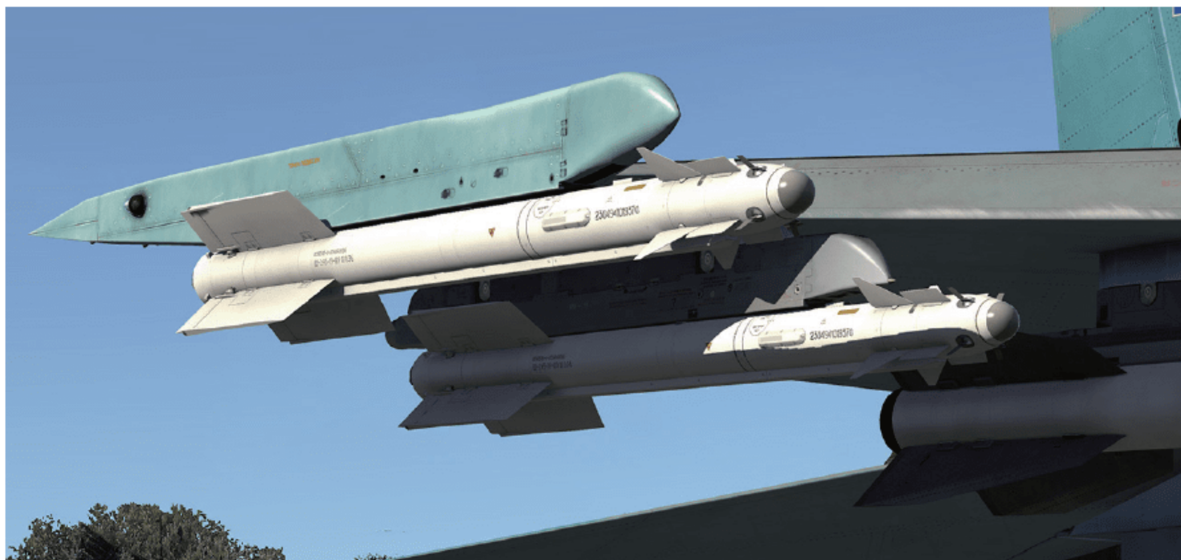
挂于机翼外侧的 R-73 导弹
