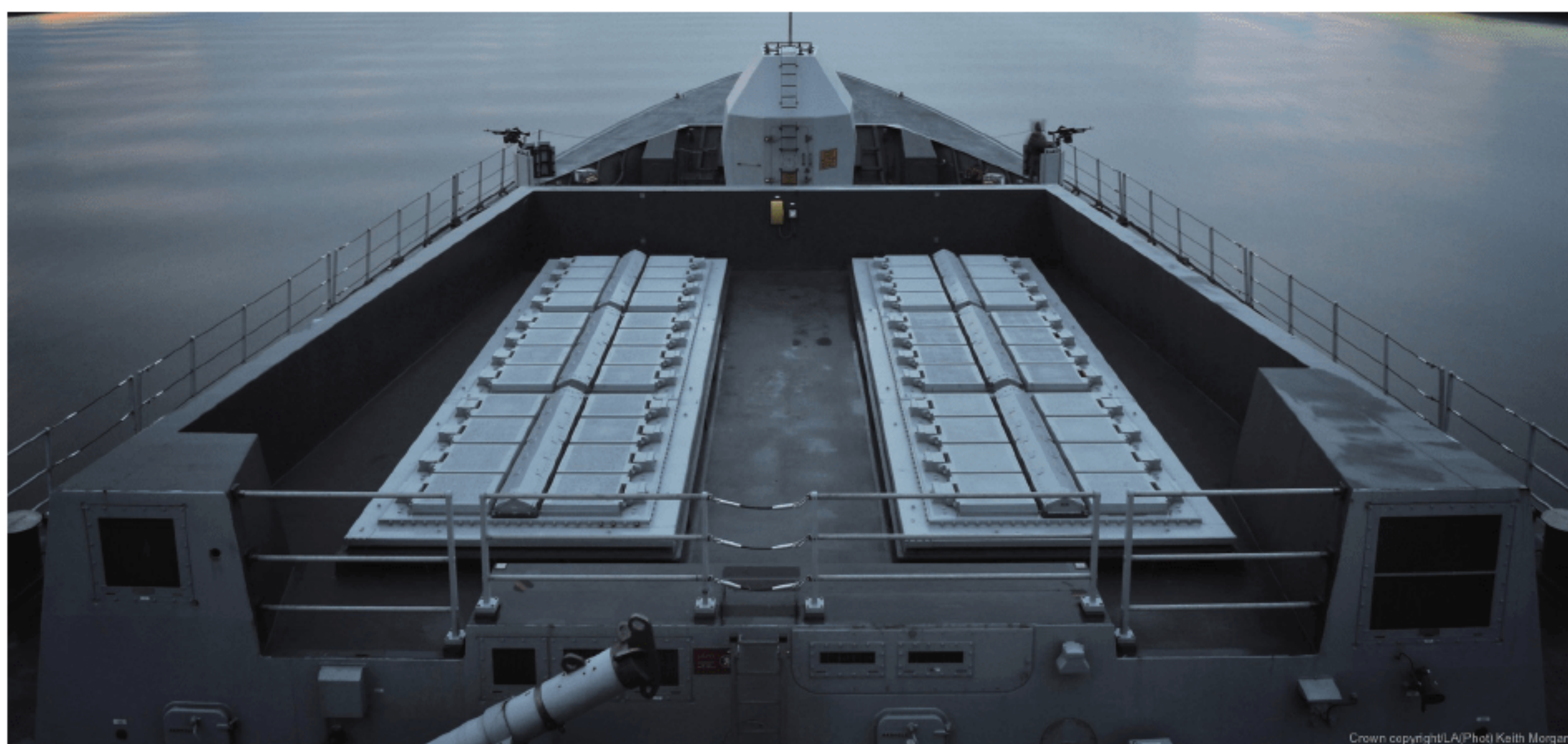
英国“勇敢”级驱逐舰的“阿斯特”导弹发射装置
