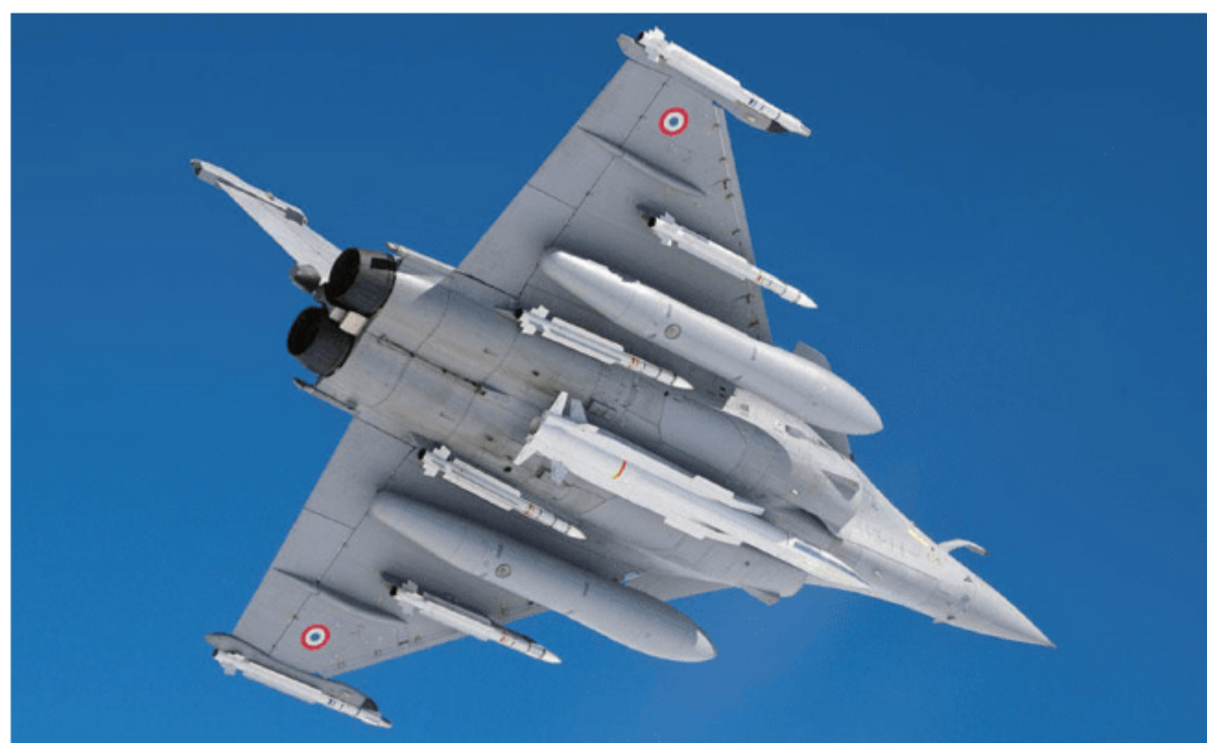
挂于机翼内侧的 ASMP-A 导弹
