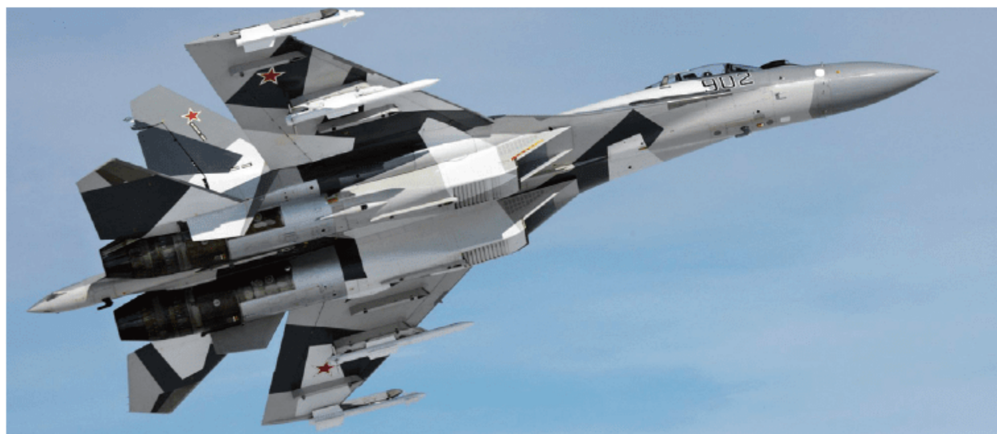
苏-35 战斗机挂载的 R-73 导弹（机翼外侧）
