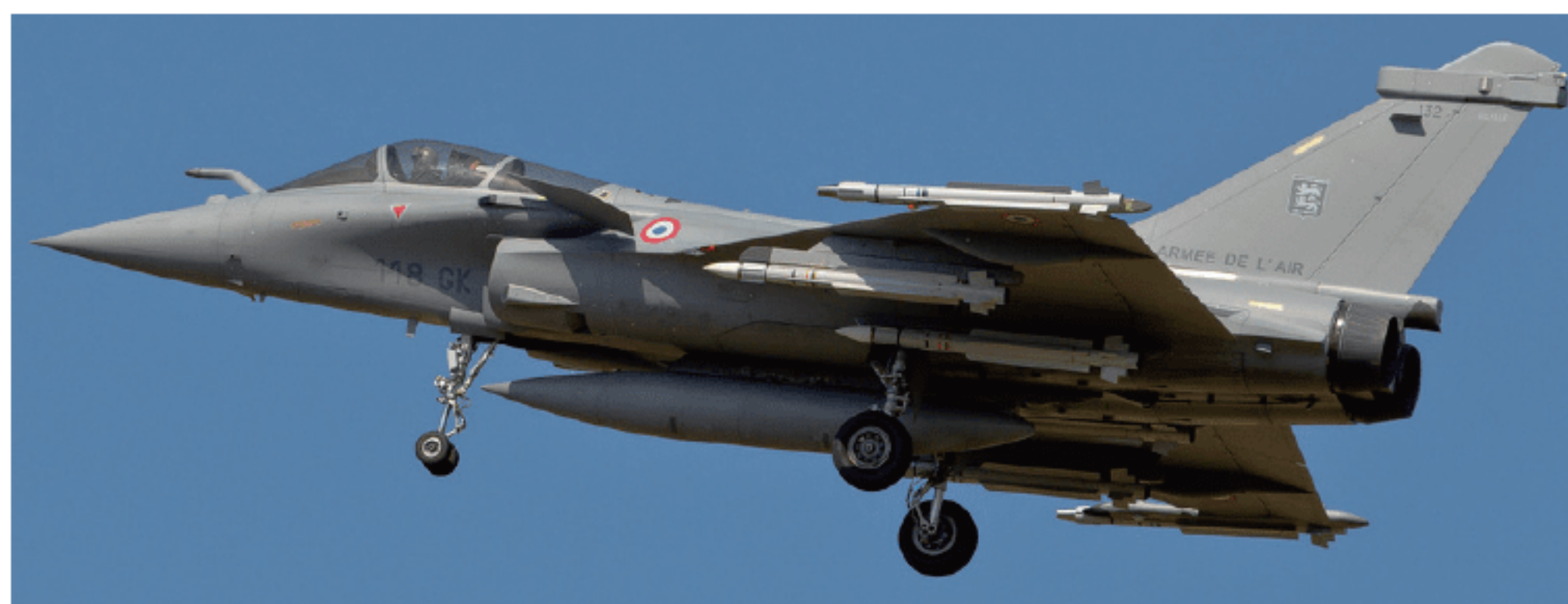
挂载于“阵风”战斗机上的“米卡”导弹
