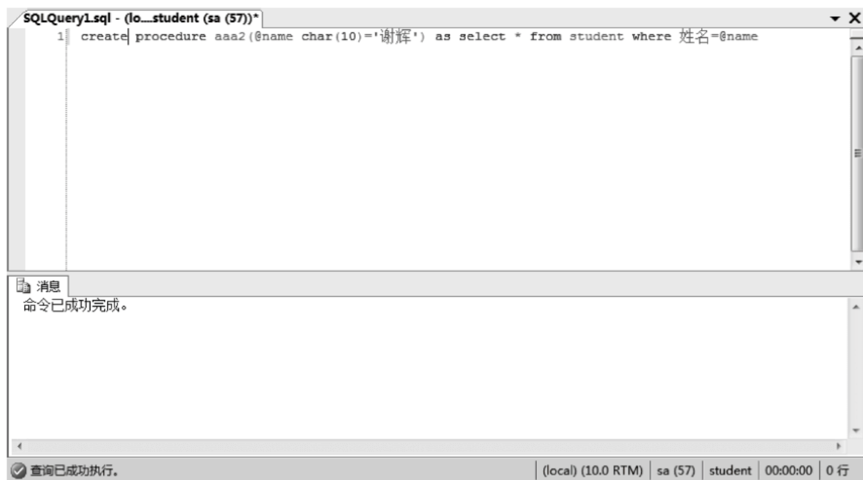
图 14-3 创建 aaa2 存储过程
