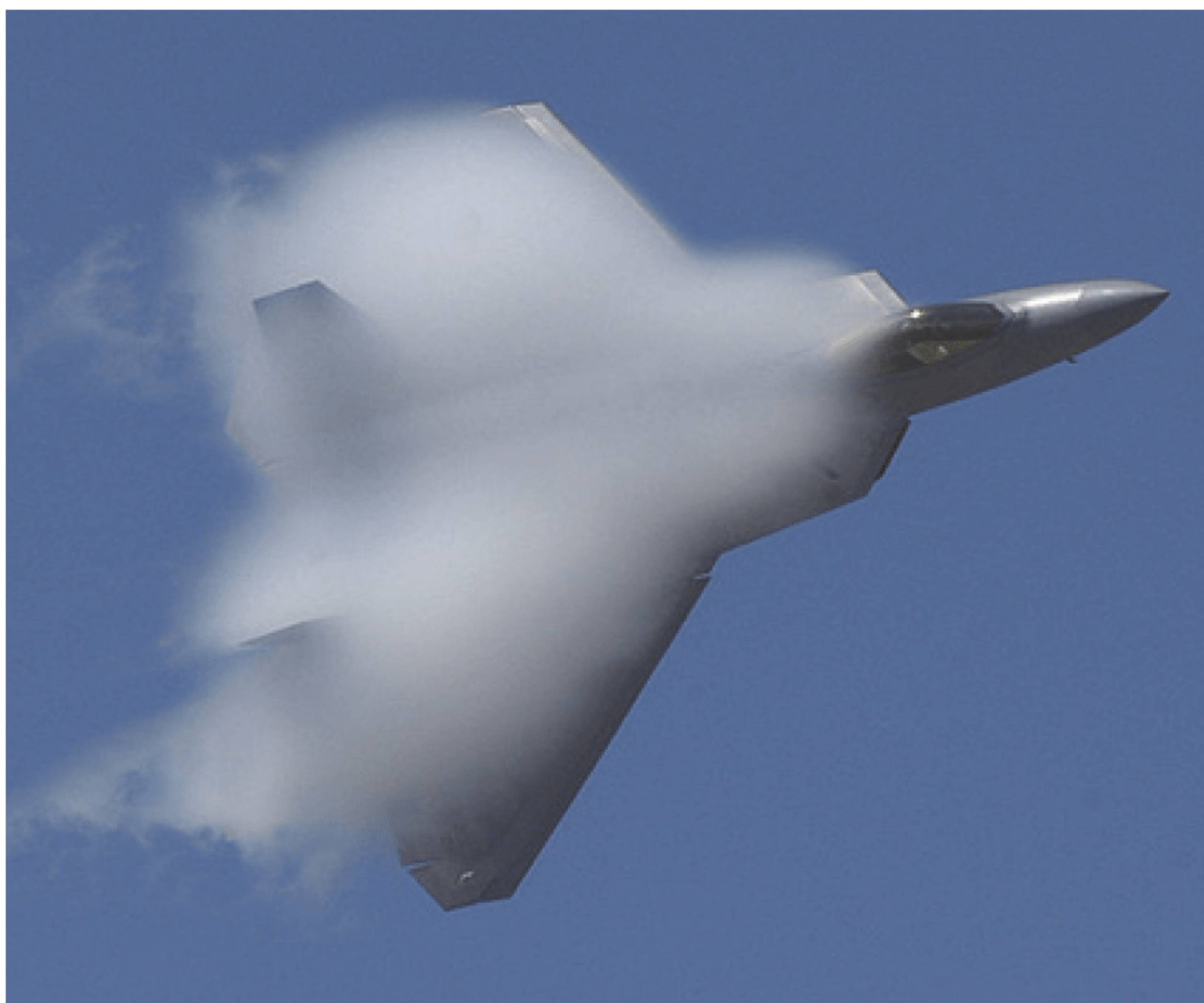
进行大角度转向中的 F-22 与翼面上产生的低压蒸汽云
