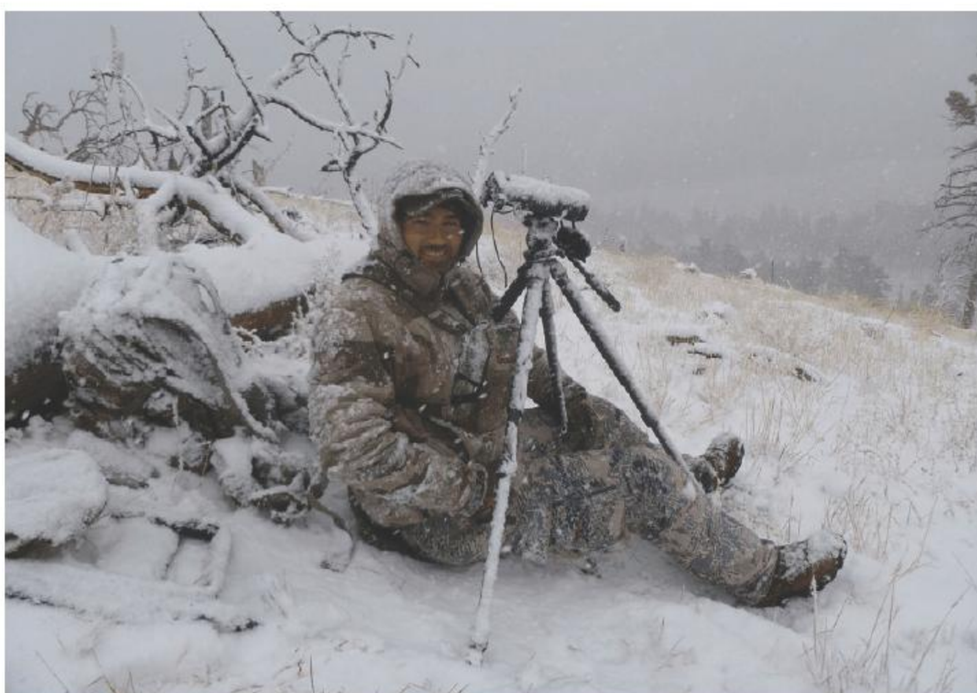
观测手配备的测距仪在低温下结冰
