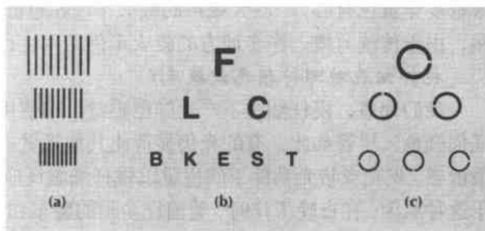
图6-10 三种通用的视力测查表示意图。(a) 线条测验,将最后仍可被看成分开的一排线条作为测查结果。(b) 斯内伦视力表(Snellen chart),将最后仍可被读出一排字母作为测查结果。(c) 朗多环(Landolt rings),将最后仍可正确说出圆环开口方向的一排作为测查结果。正常视力为20/20,即你在6米(20英尺)处的分辨力达到人们(在6米处)测验结果的平均值。如果人们在12米处可以看清的东西,你需要在6米处才能看清,那么,你的视力为20/40。如果你的视力到了20/200,则需要配眼镜。如果你的视力为20/12,则意味着你能在6米处看到别人需要到3.6米处才能看清的东西。有的宇航员(视敏度20/12)声称可以从160公里的高空看见地面上的铁轨。
